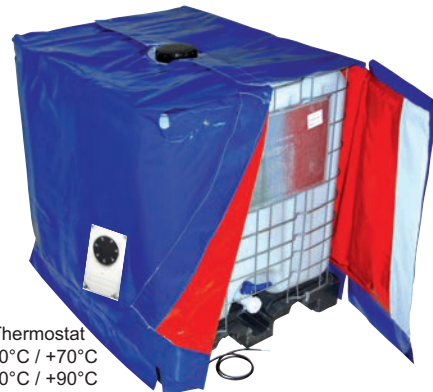
Bâche réchauffe-IBC 1000l (Plusieurs modèles) Puissances disponibles : de 1400W à 2570W – 230V Fixation par velcros (Lavables et étanches)
