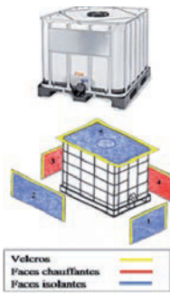
Bâche réchauffe-IBC 1000l (Plusieurs modèles) Puissances disponibles : de 1400W à 2570W – 230V Fixation par velcros (Lavables et étanches)
